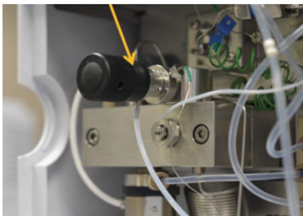
图 2：更换放空阀中的 PTFE 滤芯
